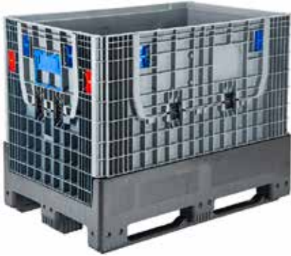
KT-1208-80 En/W Boy/L Yük/H Dış / Ext 800 x 1200 x 800 mm İç / Int 720 x 1120 x 630 mm Katlanmış Yük. Folded Height 344 mm
